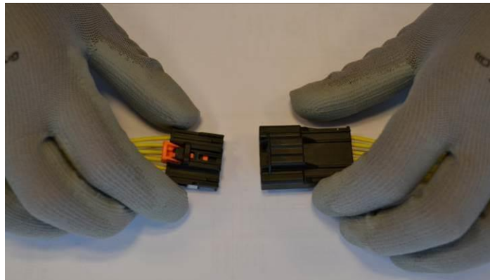
Male connector TPA preset to set / Fermeture du DV du PL:
